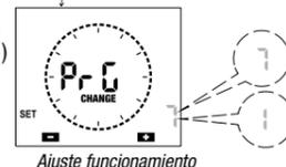
Nota: se sale de la programación incluso si no se presiona ningún botón dentro del tiempo de espera (40 segundos si el instrumento es alimentado por relé eléctrico, 10 segundos si es alimentado por la batería de respaldo). En este caso, los cambios no se guardan.
