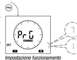
Nota: si esce dalla programmazione anche se non viene premuto alcun tasto entro il time-out (40 secondi se lo strumento è alimentato da rete elettrica, 10 secondi se alimentato con la batteria tampone). In questo caso le modifiche non vengono salvate.
