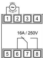
Nota: il relè monostabile commuta solo se lo strumento è alimentato da rete elettrica.
