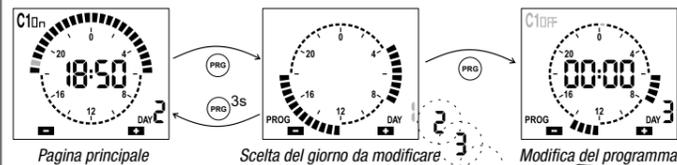
Nota: si esce dalla programmazione anche se non viene premuto alcun tasto entro il time-out (40 secondi se lo strumento è alimentato da rete elettrica, 10 secondi se alimentato con la batteria tampone). Le modifiche vengono comunque salvate.
