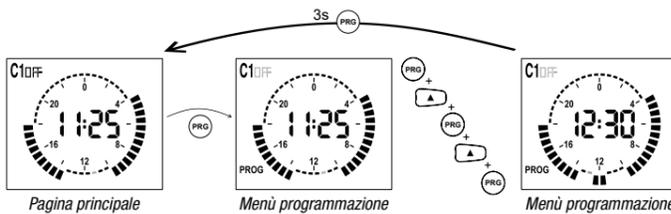
Nota: si esce dalla programmazione anche se non viene premuto alcun tasto entro il time-out (40 secondi se lo strumento è alimentato da rete elettrica, 10 secondi se alimentato con la batteria tampone). Le modifiche vengono comunque salvate.
