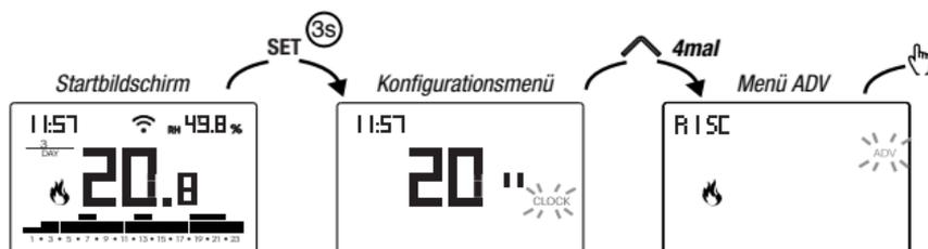
Im Menü ADV werden die Parameter, die sich auf die fortgeschrittene Konfiguration beziehen, der Reihe nach vorgeschlagen. Drücken Sie:
