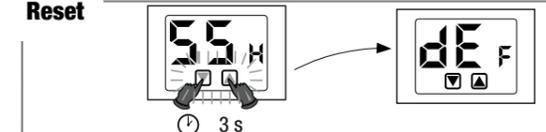
Den Hygrostaten von der Wandbasis lösen und wieder einhängen (batteriebetriebene Modelle) oder die Stromversorgung entfernen und wiederherstellen (230V-Modelle). Halten Sie die Tasten gedrückt, bis beim Blinken der Tastatur „DEF“ erscheint.
