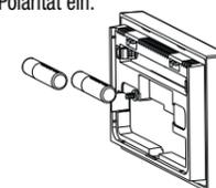
④ Haken Sie den Hygrostaten an der Basis ein, indem Sie zuerst die auf der Oberseite befindlichen Zähne koppeln.
